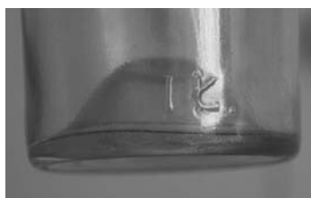
Fot. 2. Dno butelki do win niemusujących o pojemności 0,75 l ze znakami cechowania huty szkła w Hłowej k/Zagania. Fot. P. Karwowski
